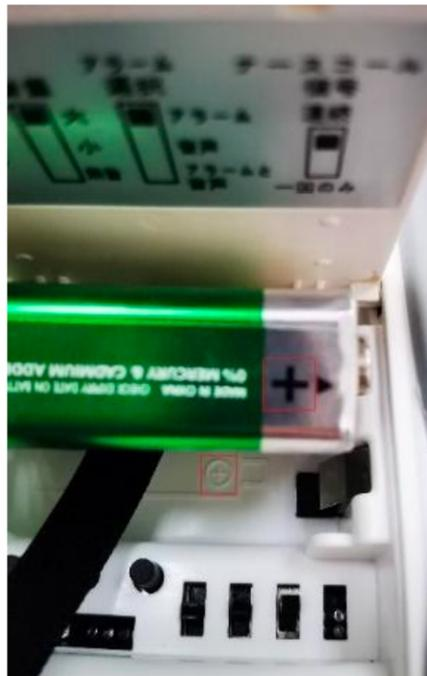
Lorsque la pile est faible, l'alarme émettra 2 bips espacés de 12 secondes et le voyant **BATTERY LOW** clignotera en rouge toutes les 4 secondes.
