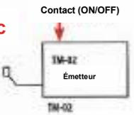
Mettre sous tension en utilisant le contact (ON/OFF) sur le côté de l'émetteur
